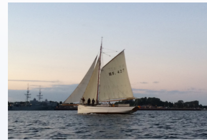
MARTHA , Elbfischer Baujahr/Bauort: 1925, Hamburg L x B x T: 12m, 3,m, 0,8m Motor/Segelfläche: 60PS/95m
