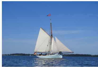
FRIEDA , Haikutter Baujahr/Bauort: 1918, Holbaek L x B x T: 14m, 4,1m, 1,9m Motor/Segelfläche: 90PS/110m
