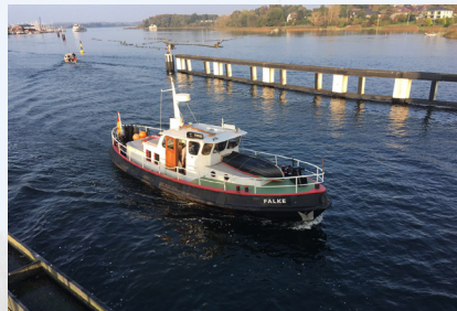
SEEFALKE , Lotsenversetzer Baujahr/Bauort: 1958, Kiel L x B x T: 8m, 3m, 1,5m Motor/Segelfläche: 60PS/ -
