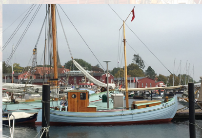
VEGA , Sundboot Baujahr/Bauort: 1943, Simrish. L x B x T: 8m, 3,0m, 1,15m Motor/Segelfläche: 15PS/12m
