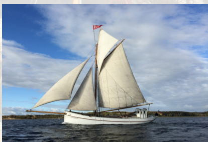
RUTH , Haikutter Baujahr/Bauort: 1917, Aarhus L x B x T: 17m, 4,6m, 2,1m Motor/Segelfläche: 100PS/120m
